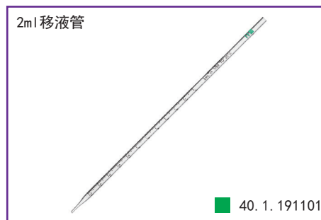
管内带滤芯 不同容量规格对应不同的色标
